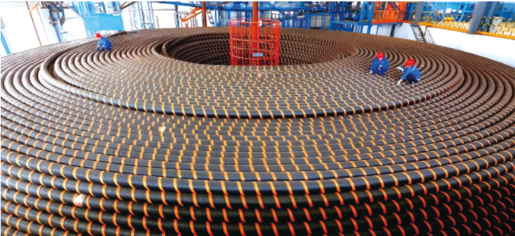
青岛汉缆股份有限公司的工人在生产海缆产品。(常青 摄)
