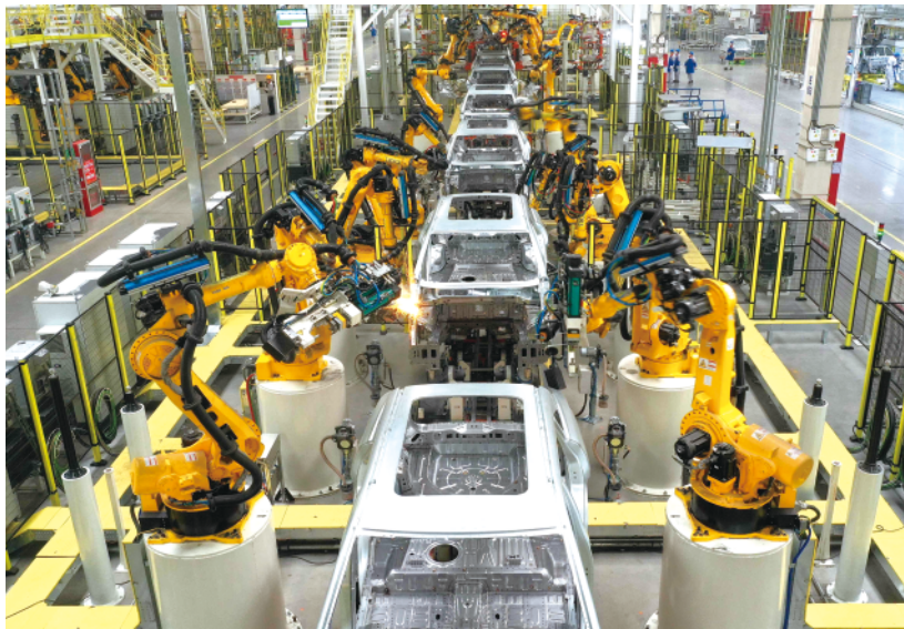
奇瑞汽车青岛基地焊装车间内,机器人在进行焊接作业。常青 摄
