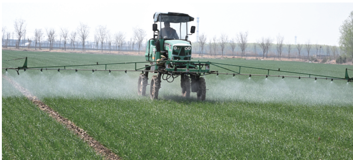
农民驾驶自走式高杆喷雾机对小麦进行喷药作业。
