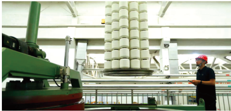
即发集团超临界二氧化碳无水染色产业化示范线。范宝琛 摄
