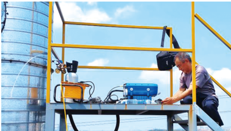
监测人员正在对企业废气排气口进行采样分析。
