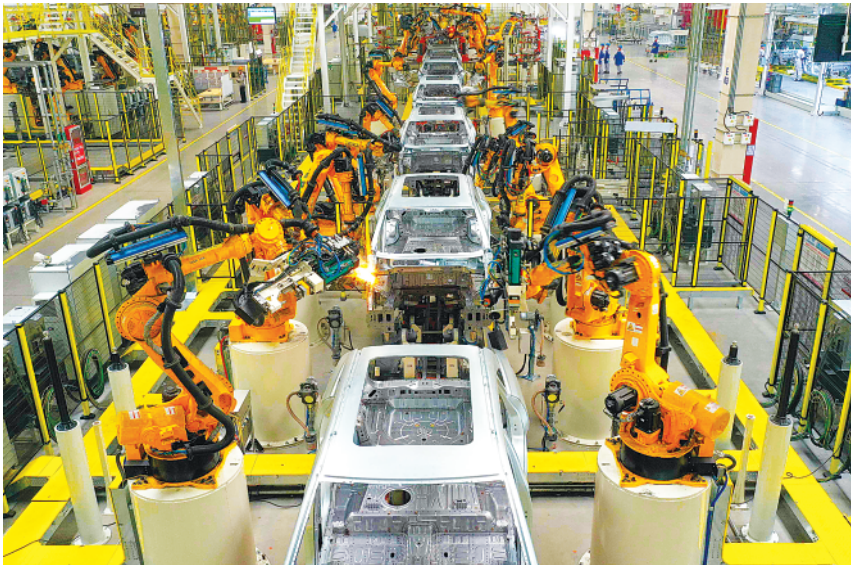
奇瑞汽车青岛基地焊装车间内,机器人在进行焊接作业。常青 摄
