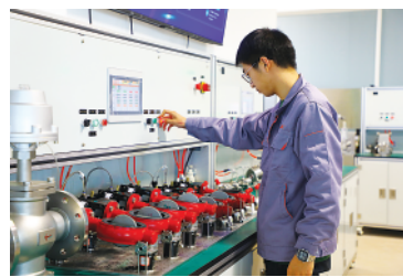
检测中心试验员进行产品疲劳测试。
