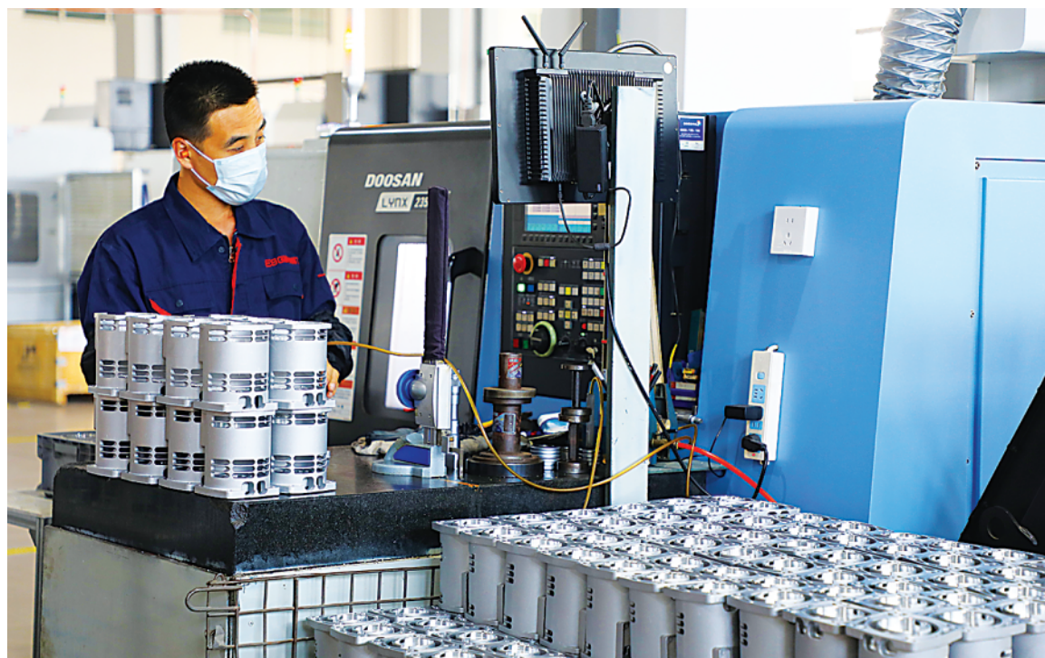
操作工用气动量仪测量出口的高精度零件。
