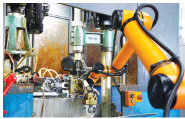
协作机械手加工角阀缸筒。
