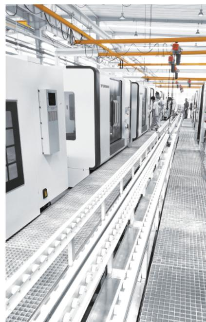
卧式加工中心转向节生产线。
