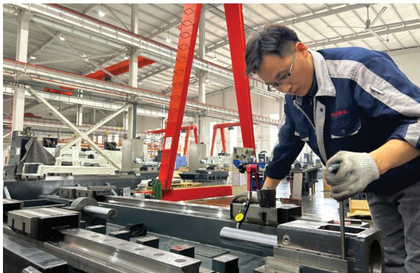
工人正在调整机床精度。
