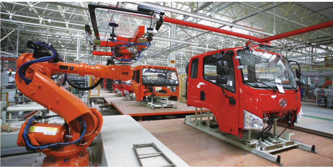
一汽解放青岛汽车有限公司卡车前挡风玻璃自动安装。(梁孝鹏 摄)
