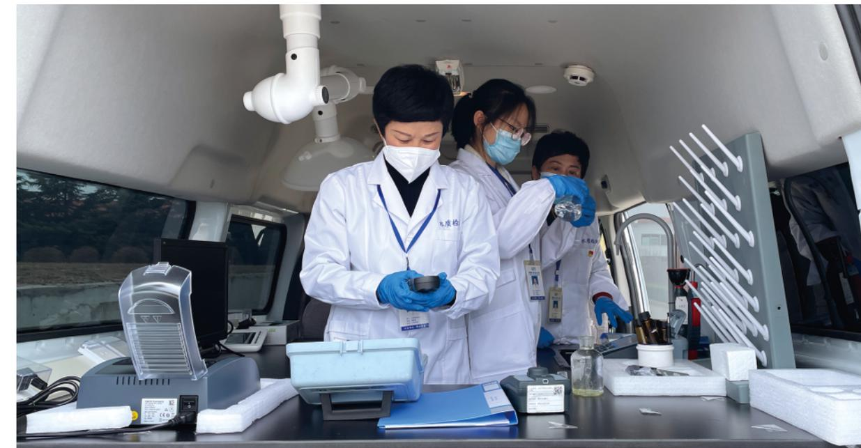
水质检测人员在水质移动监测车上快速检测水样。
