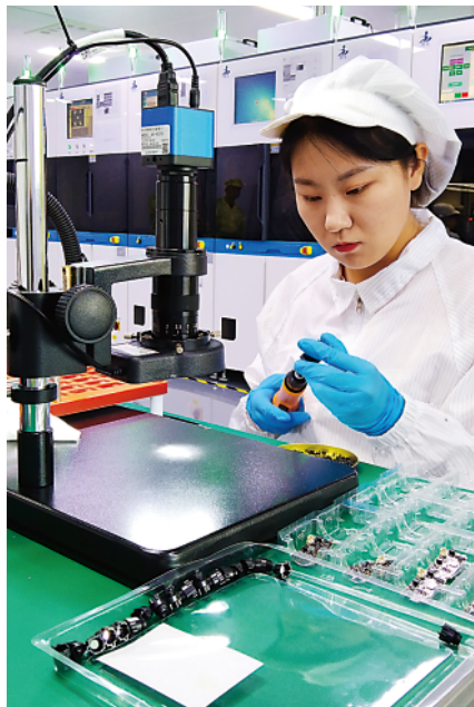
电子车间,摄像头调焦检查。
